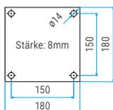
Tragkraft pro Bohrung min. 30'000 N (z.B. M12 Schraube)
