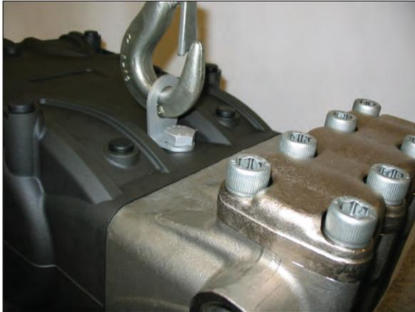
Sollte ein Ausbau der Pumpe erforderlich sein, verschließen Sie die Gewindebohrung mit dem mitgelieferten Verschluss, um das Eindringen von Schmutz in die vordere Gehäuseseite zu verhindern.
